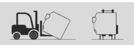
Forklift bıçaklarının düz ve pürüzsüz olmasına dikkat edin. Büyük depolan indirirken uzun bıçaklar kullanın. Eğer yuvarlanma veya kayma ihtimali varsa, tankı forklift mastına (direğine) bağlayın.
