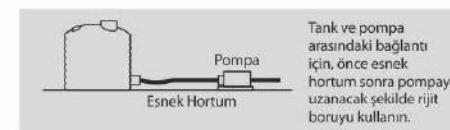
Tank ve pompa arasındaki bağlantı için, önce esnek hortum sonra pompaaya uzanacak şekilde rıjıt boruyu kullanın.
