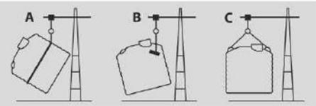
Depoya askı sapanları takılarak indirilebilir (A). Deponun üst kısmındaki ağıza sağlam bir boru/profil geçirilerek, çengel veya halatla kaldırılabilir. (B). Taşıma kulplarını kullanarak da indirebilirsiniz (C).
